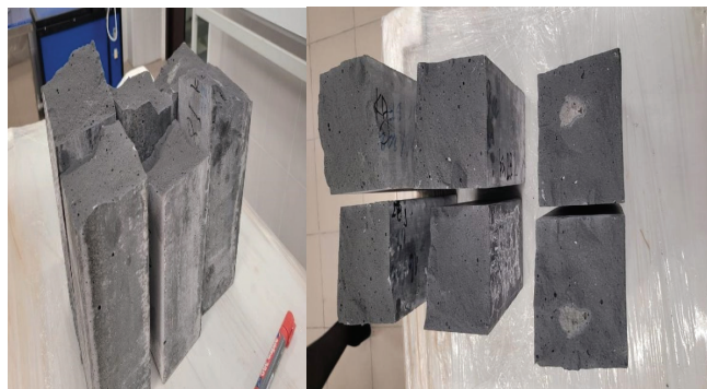
Рисунок 7. Вид призматических образцов после разрушения (Тагарист).
