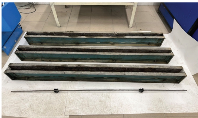
Рис.9. Металлическая опалубка балки с размерами 1420*120*50 мм
