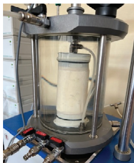
Рис.1. Прибор АСИС с моделью во время эксперимента
