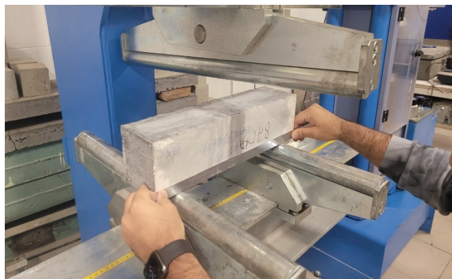
Рисунок 5. Испытание на трехточечный изгиб (Тагарист).
