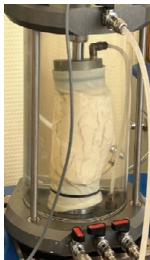
Рис. 4. Деформирование образца в эксперименте № 3
