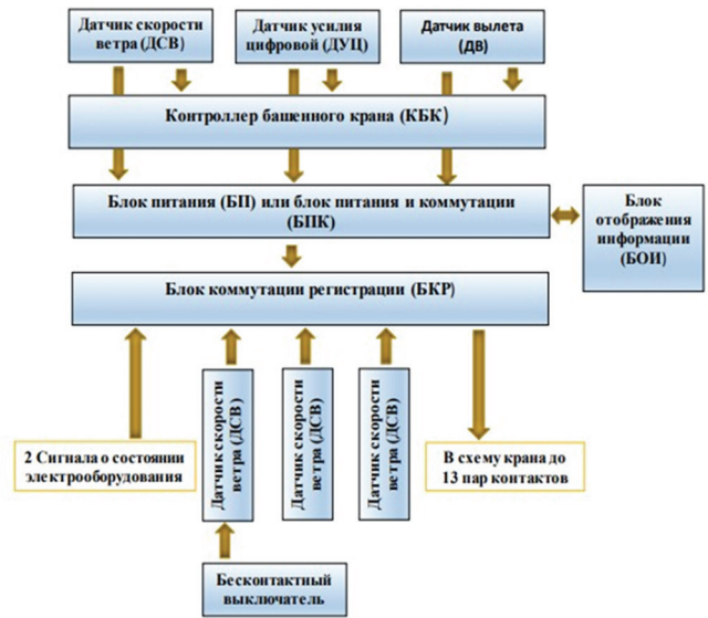
Рисунок 2 – Алгоритм системы безопасности ОНК-160Б
