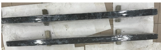
Рис.10. Железобетонные балки после распалубки покрытой пленкой
